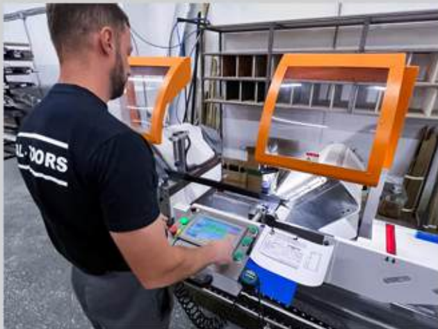
Обработка двухголовый центр с ЧПУ для резки алюминиевого профиля под 45° и 90°
